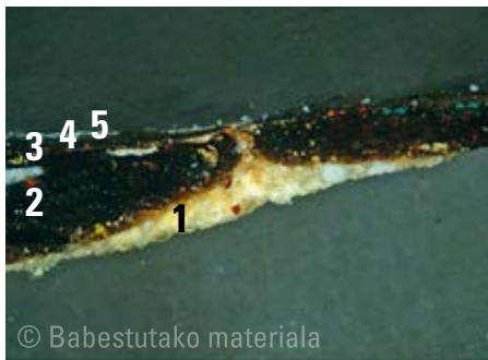
14. Natura hila frutarekin, alfonbra turkiarrarekin eta liburuarekin. Ezkutuan dauden elementuetako batetik (fruta bat?) hartutako lagin baten ebakidura estratigrafikoa: 1, Napoliko horiz eta berunaren zuriz osatutako pintura-geruza (30 \mu m); 2, lurrez, berunaren zuriz, hezurretako beltzez eta proportzio txikiko kaltzio karbonatuz, igeltsuz eta gardingaz osatutako pintura-geruza (60 \mu m); 3, berniz-geruza (10 \mu m); 4, ukutua, ziurrenik ez jatorrizkoa, hezurretako beltzez osatua (0-2 \mu m); 5, berniz (15 \mu m)
